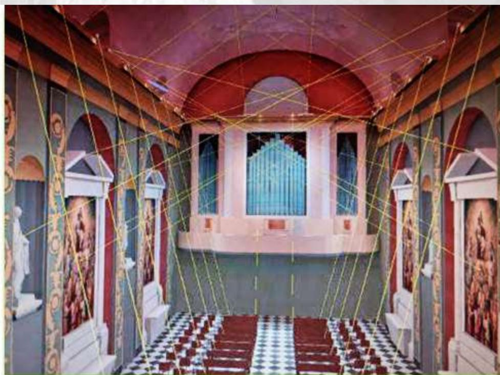
Fig.3 – Schema generale del nuovo impianto di illuminazione
